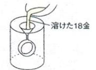
溶けた金属(湯)を空洞のリングに流しこみます。(吸引鑄造、遠心鑄造)
