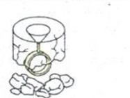
石コウをくずして中の18金リングをとり出します
